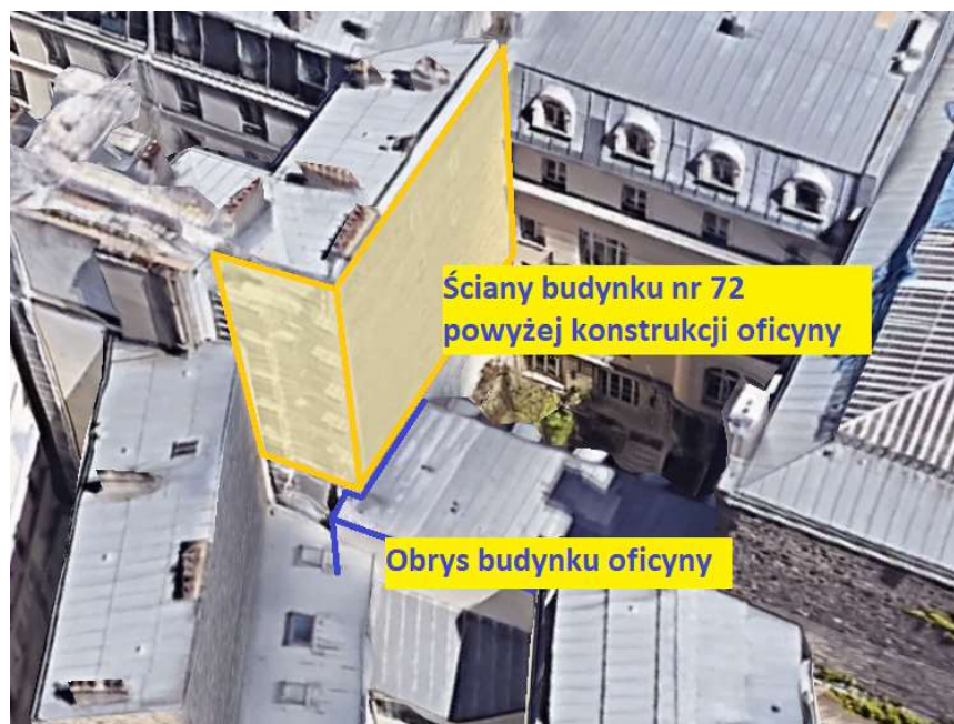
Rys. 8. Schemat styku obiektów przy spękanej ścianie
